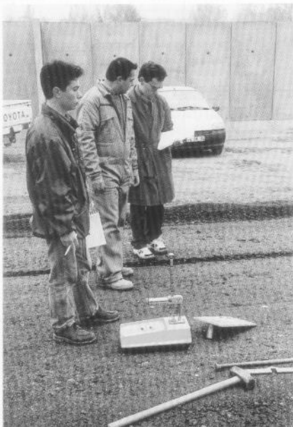
Mesure de densité de MIOM compactés par gammadensimètre
