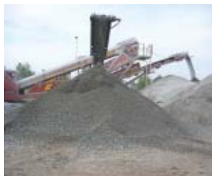
Flux et stocks de matériaux après traitement à la chaux
