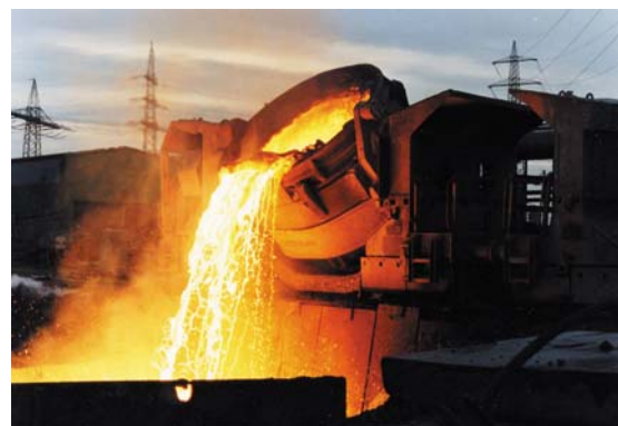
Coulé du laitier en fosse de refroidissement
