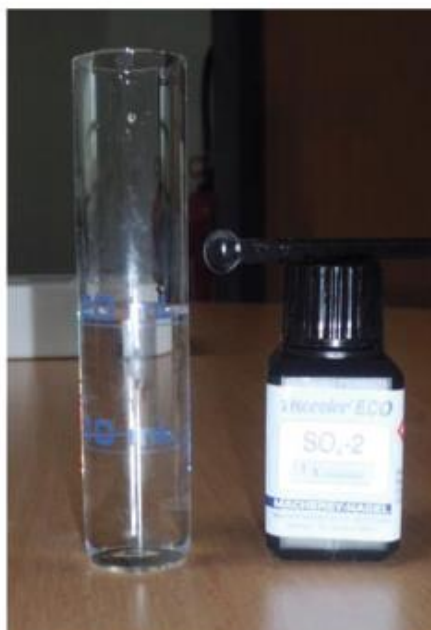
Etape 5 : Sélectionner le flacon contenant le réactif SO_4 - 2 et sa cuillère.
