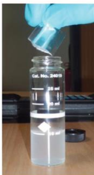
Etape 5 : Vider le contenu d'un sachet de Sulfaver dans ce flacon. Fermer le flacon et agiter le mélange pendant quelques secondes.
