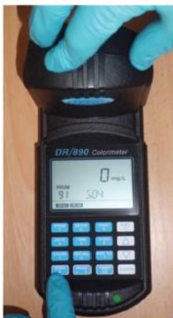
Etape 10 : Placer le couvercle au-dessus du flacon et appuyer sur le bouton ZERO . Puis retirer le flacon « Blanc ».
