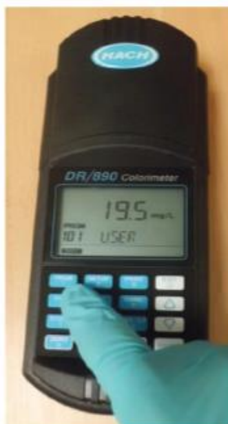
Etape 2 : Appuyer sur le bouton PRGM pour sélectionner le programme d'analyse souhaité
