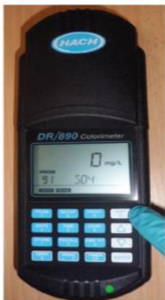
Etape 1 : Appuyer sur le bouton EXIT pour allumer l'appareil. Après initialisation, le dernier programme de mesure utilisé et la dernière concentration affichée apparaissent
