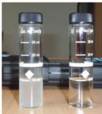
Etape 7 : Pendant ce temps, préparer un second flacon avec 10 mL d'échantillon sans réactif Sulfaver (tube Blanc).
