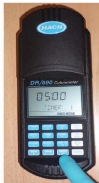
Etape 6 : Laisser le flacon au repos pendant 5 min pour que le trouble se développe. Appuyer sur le bouton TIMER pour lancer le chronomètre.
