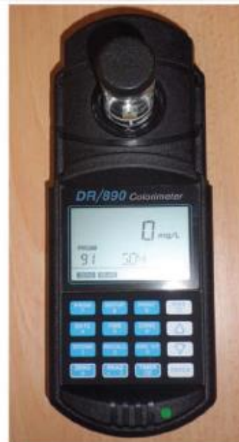
Etape 9 : Introduire le flacon « Blanc » dans l'orifice de l'appareil
