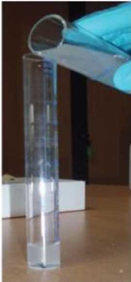
Etape 7 : Verser la solution dans le tube le plus étroit jusqu'à ce que la croix située au fond du tube (Fig. a) disparaisse (Fig. b).
