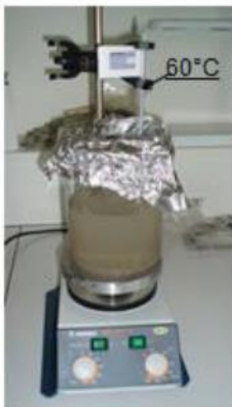
Etape 2 : Couvrir le béccher et mettre en agitation en prenant soin de vérifier que l'ensemble des grains est en mouvement. Mettre en chauffe pour maintenir la température à 60°C et laisser agiter au moins 15 min (maximum 45min).
