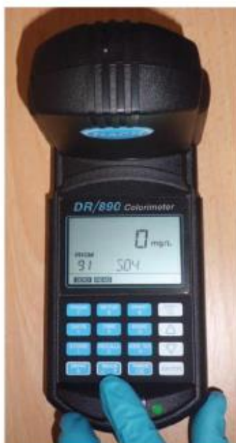
Etape 11 : Introduire alors le flacon contenant l'échantillon dans l'orifice de l'appareil. Placer le couvercle au dessus du flacon. Appuyer sur le bouton READ .
