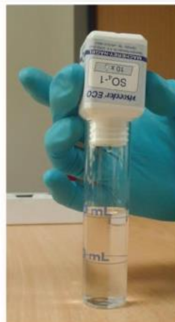
Etape 3 : Insérer 10 gouttes de la solution SO_4 - 1 dans le tube d'échantillon.
