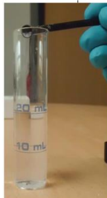
Etape 6 : Ajouter une cuillerée de réactif SO_4 - 2 dans le tube contenant l'échantillon. Homogénéiser de nouveau jusqu'à solubilisation complète du réactif.
