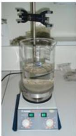
Etape 1 : Introduire la prise d'essai de 25 g dans un béccher de 2000 mL. Ajouter 1000 g d'eau déminéralisée préalablement chauffée à 60°C.
