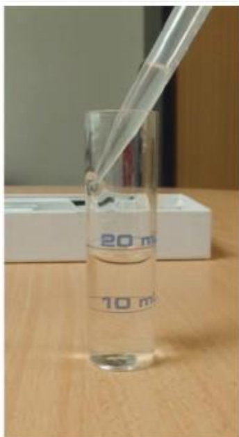
Etape 1 : Insérer 20 mL de solution à doser dans le tube le plus large.
