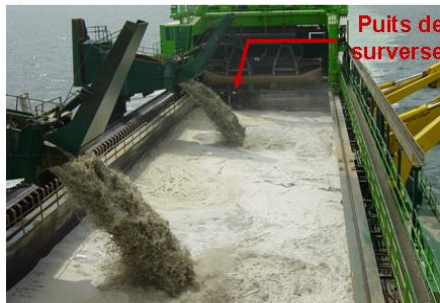
Figure 6 : Principe de l'extraction en marche de granulats marins à l'aide d'un navire extracteur
