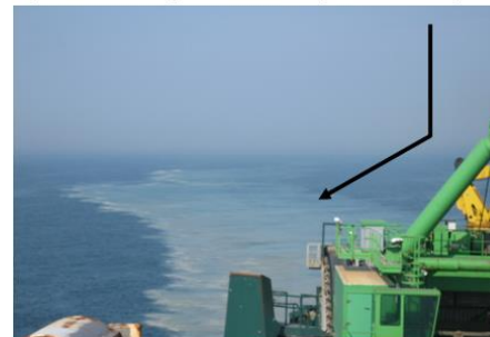
Figure 6 : Principe de l'extraction en marche de granulats marins à l'aide d'un navire extracteur
